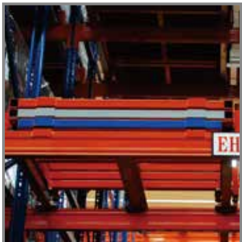
不同的台车可采用不同的颜色，方便操作 Carts in different colors to identify the depth
